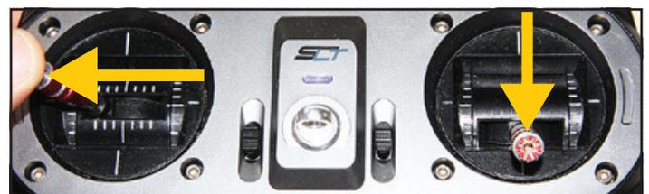
\* Si vous laissez les gaz coupés durant un temps plus ou moins long suivant le paramétrage du CC3D, les moteurs se reverrouillent automatiquement et vous devez refaire une procédure de déverrouillage pour pouvoir faire tourner à nouveau les moteurs.
