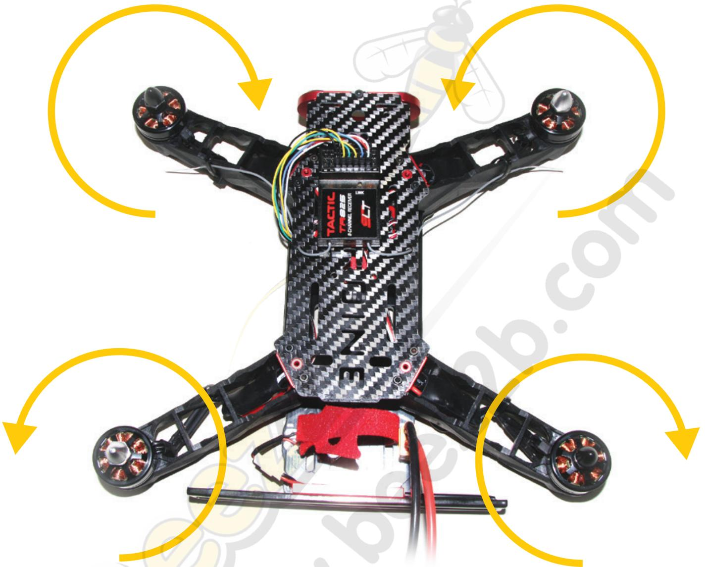
\* Pour les moteurs qui ne tournent pas dans le sens correct, vous devez intervertir deux connexions sur les trois qui relient le contrôleur au moteur. Ceci inverse le sens de rotation du moteur.
