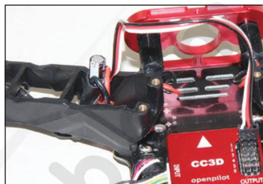
\* 5 - Connectez le fil du contrôleur du moteur avant droit sur la prise notée 2 du CC3D. (A droite)
