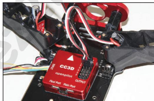
\* 6 - Connectez le fil du contrôleur du moteur arrière droit sur la prise notée 3 du CC3D. (A gauche)
