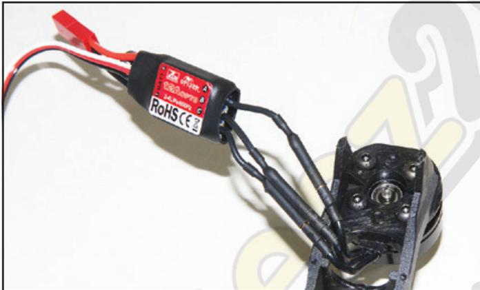
\* 2 - Connectez les contrôleurs aux prises correspondantes soudées au châssis. Respectez les polarités.
