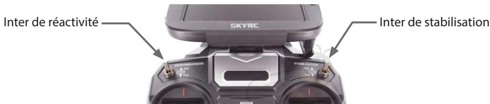
Pour les utilisateurs avancés, vous pouvez passer l'inter de réactivité sur "Fast" (rapide) et celui de stabilisation sur "Low" (faible). Le drone sera alors plus agile et plus réactif.
