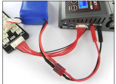
**ATTENTION : Ne pas respecter l'ordre des connexions de ce diagramme endommagera le chargeur. Pour éviter les courts-circuits entre les cordons de charge, branchez toujours les cordons de charge en premier sur le chargeur, et ensuite branchez l'accu. Procédez en sens inverse pour la déconnexion.**
